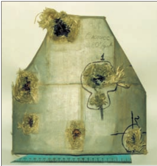
Керамическая панель VI класса защиты из корунда после испытаний
