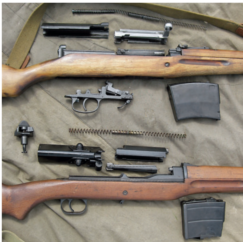
Неполная разборка СВТ-40 (вверху) и AG42В
