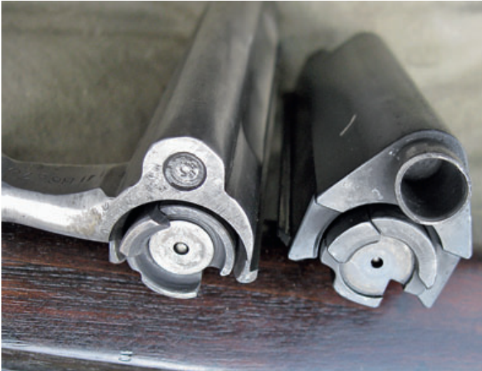
Передняя часть затворных групп СВТ-40 (слева) и АГ42В (справа)
