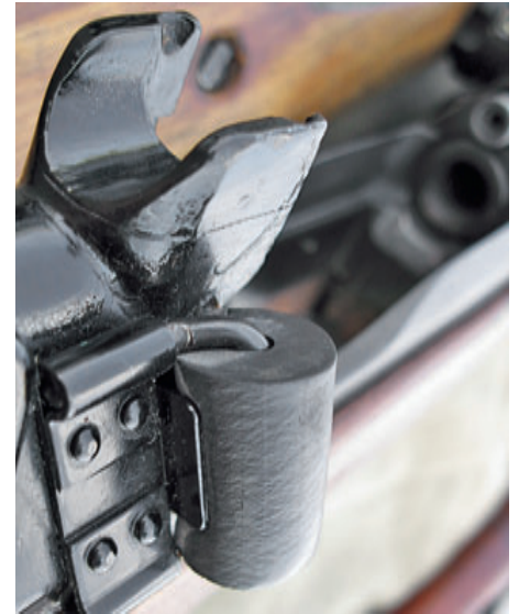
Приёмник обоймы и резиновый валик-отбойник гильз
