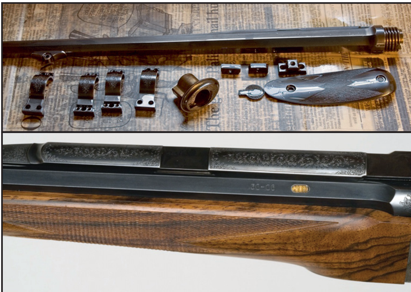
Воронение оксидированием – самый популярный метод отделки штучного оружия. На верхней фотографии – ствол и десять мелких деталей выдерживаются в масляной ванне после воронения. Ствол на нижней фотографии демонстрирует глубокое глянцевое воронение оксидированием, без всякого матирования и повреждения гравировки
