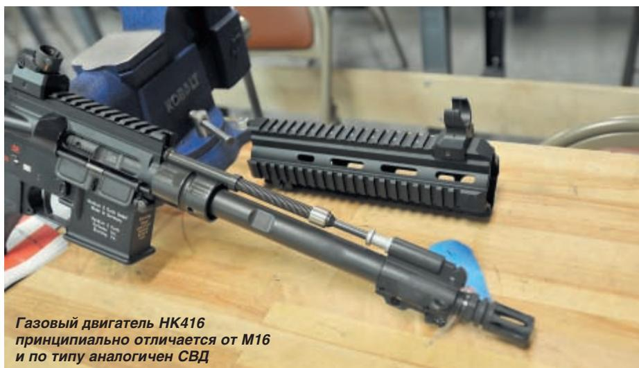
Газовый двигатель HK416 принципиально отличается от M16 и по типу аналогичен СВД
